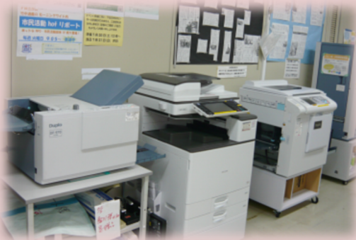
左から、紙折り機、コピー機、印刷機、ページセッター
